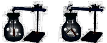
contacto con la esfera del electroscopio. En la imagen, se representan los resultados obtenidos a partir del procedimiento. Las láminas de cobre se repelen.
