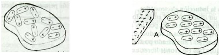
El efecto de polarización consiste en que el estado final de un dieléctrico que al estar cerca de un cuerpo electrizado, es hacer que en un extremo de él se encuentren cargas negativas y en el otro extremo cargas positivas, en presencia del cuerpo inductor.
